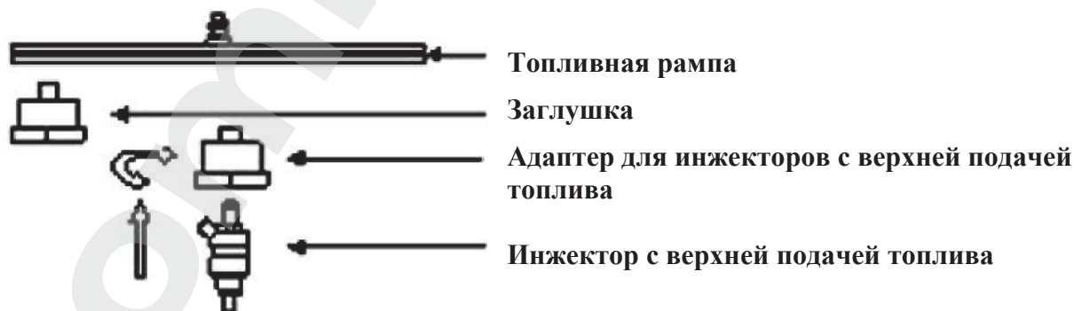
Рис. 2.1 Установка адаптера инжектора с верхней подачей топлива
