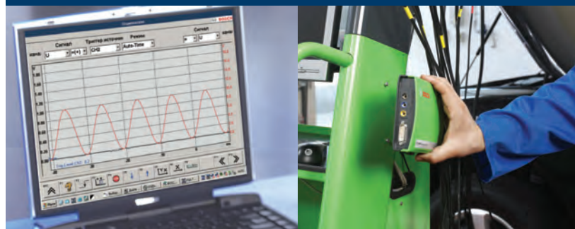
Измерения осциллографом параллельно с системной диагностикой
